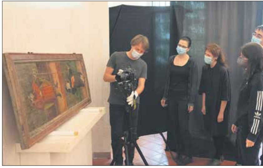
3-D-Datenerfassung mittels Fotogrammetrie.
