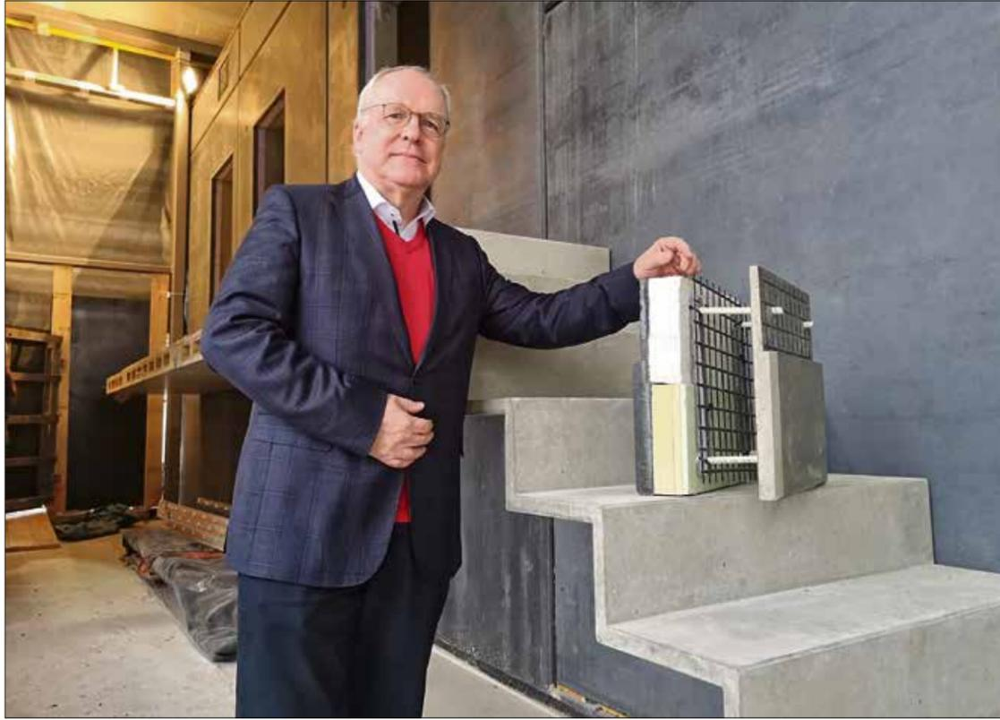
Bauherr und Carbonbeton-Erfinder Prof. Manfred Curbach demonstriert anhand des Aufbaus einer Treppe und eines Musters, wie dünn und doch stabil mit dem neuartigen Werkstoff gebaut werden kann. Foto: Heiko Weckbrodt
