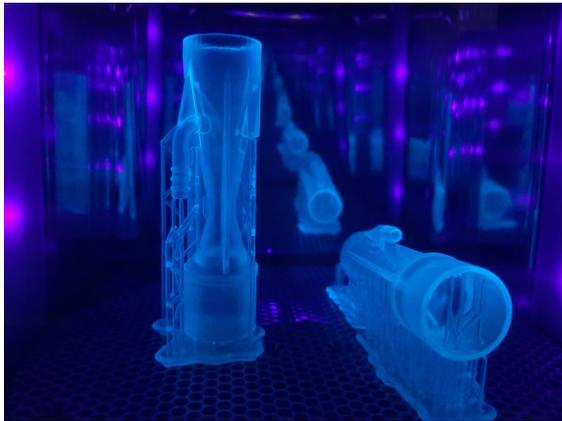
Ein additiv gefertigtes Ventil für Beatmungsgeräte aus dem 3D-Drucker der DRESDEN-concept-Partner.
