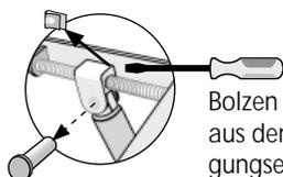
Bolzen aus dem Befestigungselement an der Gegendruck-Einstellung entnehmen
