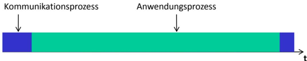
Abbildung: Kommunikationsverlauf beim Einsatz von Kommunikationsprozessoren
