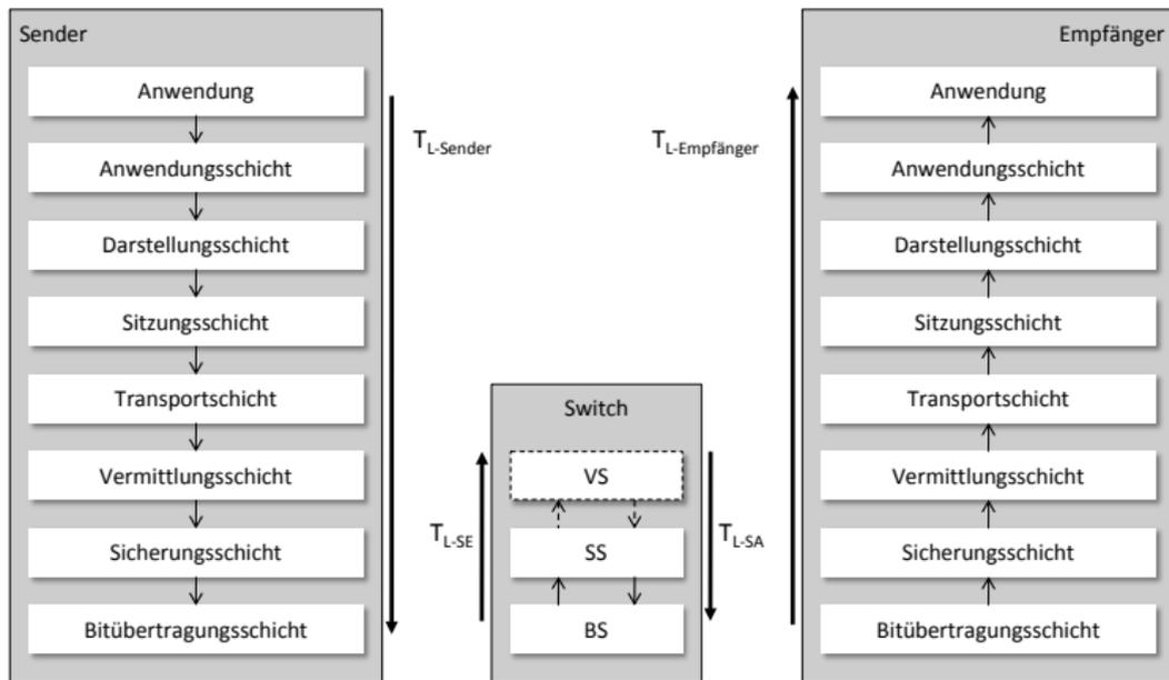
Abbildung: Zusammensetzung der Latenzzeit innerhalb einer Fabric
