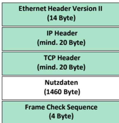
Abbildung: Protokoll-Overhead von Ethernet mit TCP/IP
