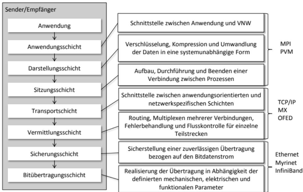
Abbildung: Open Systems Interconnection Reference Model
