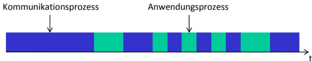
Abbildung: Kontextwechsel bei Kommunikation ohne Hardwareunterstützung
