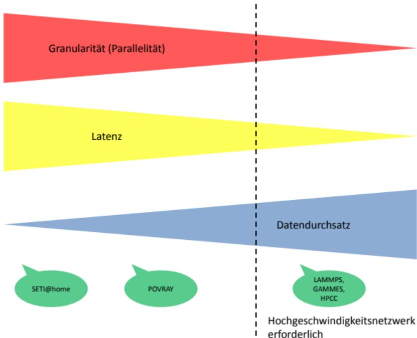
Abbildung: Zusammenhänge zwischen Granularität, Latenz und Datendurchsatz
