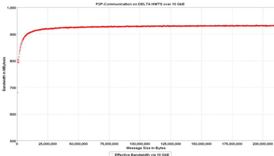
Abbildung: Datendurchsatz mit MPI über 10-Gigabit-Ethernet
